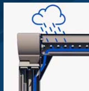
En cas de pluie, l'eau est rapidement évacuée grâce au système de drainage intégré.
